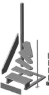
2. В внешнем углу устанавливают столб 80х80х2300 мм (поз. 5). Встык с основанием ступени устанавливают круглый металлический столб (поз. 4).
