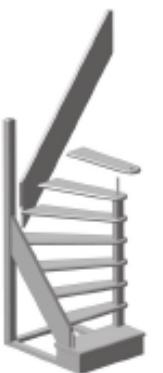
5. В паз столба устанавливают среднюю струну 2255x300 мм (поз. 10)
