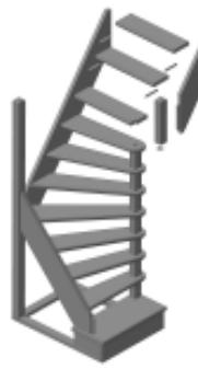
8. В паз столба заводят шип верхней струны (поз. 20) и крепят её саморезами 3,5x70 мм.
