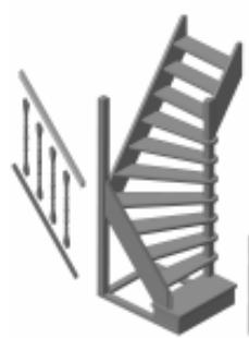
9. Между установленной верхней струной 1030x300 мм (поз. 20) и средней струной (поз. 10) металлическими уголками крепятся оставшиеся прямоугольные ступени (поз. 21, 3 шт.).
