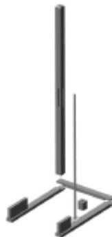
1. Сборку лестницы начинают соединив основание из трех нижних связок (поз. 1, 2 и 3). Связки располагают под прямым углом. Между собой их скрепляют саморезами 3,5x35 мм.
