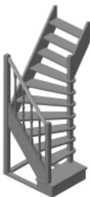
10. На первую нижнюю ступень устанавливается столб с пазом под нижнюю струну 80х80х1200 мм (поз. 22). Отдельно собирают конструкцию из 4 балансин с углом 48 градусов (поз. 24), их основания и поручня (поз. 23 и 25).
