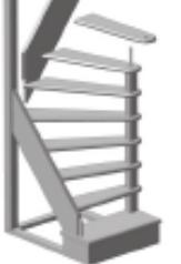
6. Собранный конструкции размещают в месте установки и крепят к несущим перекрытиям дома (крепеж в комплект поставки не входит). На круглый столб заводят оставшиеся три ступени с отверстием (поз. 17-19) и муфты. Свободные края ступеней прикрепляют к струне уголками и саморезами 3,5x35 мм.
